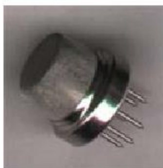
图 3.2 MQ-2 型传感器的外观
