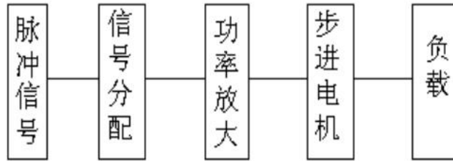
图 3 步进电机工作原理方框图
