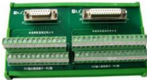
图 3 plc 侧接线端口
