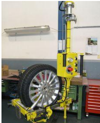
图 1-1 气动助力机械手搬运轮胎
