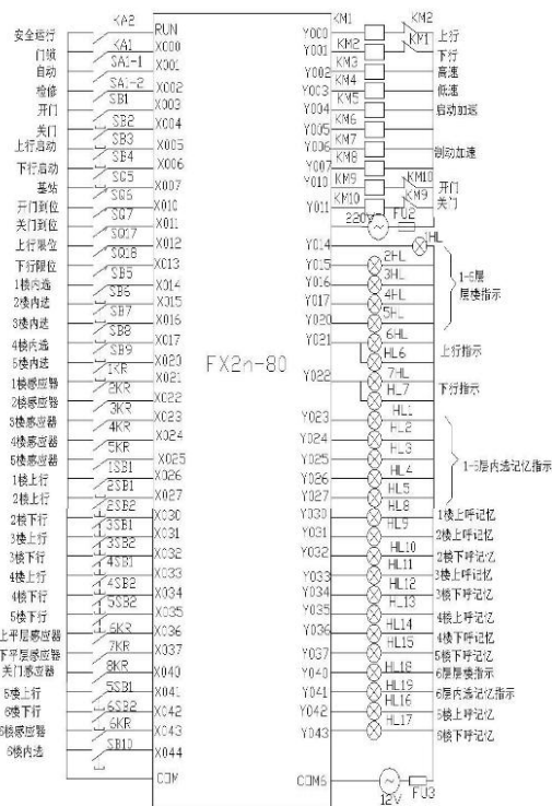
图 1 输入输出电路图
