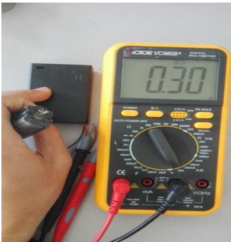
图 7 电流档测电流
